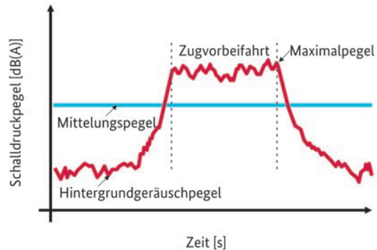
Abbildung 04: Grafische Darstellung des Zusammenhangs zwischen dem Schalldruckpegel und dem Mittelungspegel am Beispiel einer Zugvorbeifahrt.
