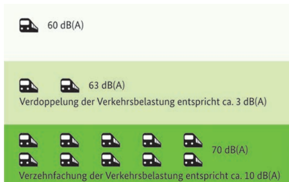
Abbildung 03: Addition des Schalldruckpegels bei Verdopplung oder Verzehnfachung der Verkehrsbelastung.
