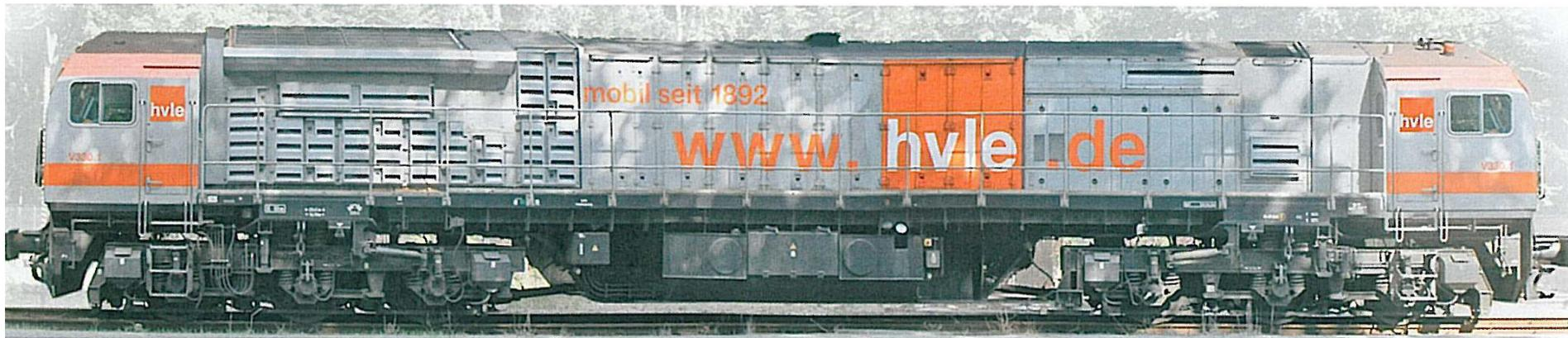
Leistung 2500 kW, Anfahrzugkraft 517 kN,  $V_{max}$  120 km/h, Masse 126 t, Länge 23410 mm, 7 Loks bewährt seit 2008
