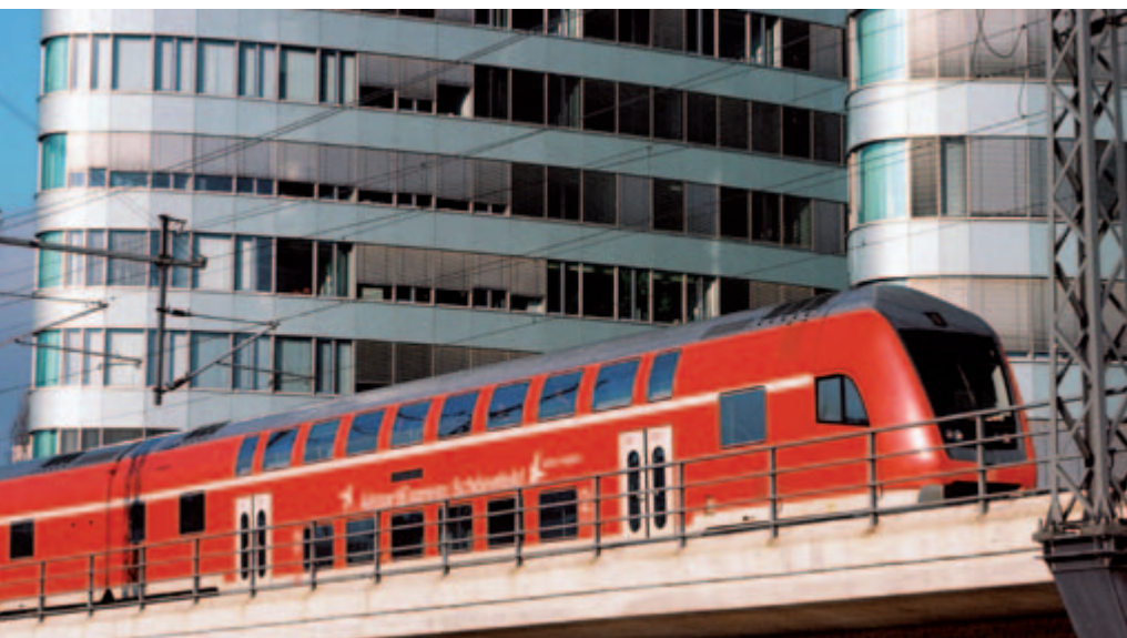
Die Züge des Nahverkehrs sind weitestgehend mit Scheibenbremsen ausgestattet, dadurch können die Schallemissionen deutlich reduziert werden
